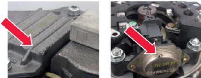
Abbildung 1: Durch einen Kurzschluss verursachte Brandspuren an den Anschlüssen (oben) und am Regler (links und rechts)
