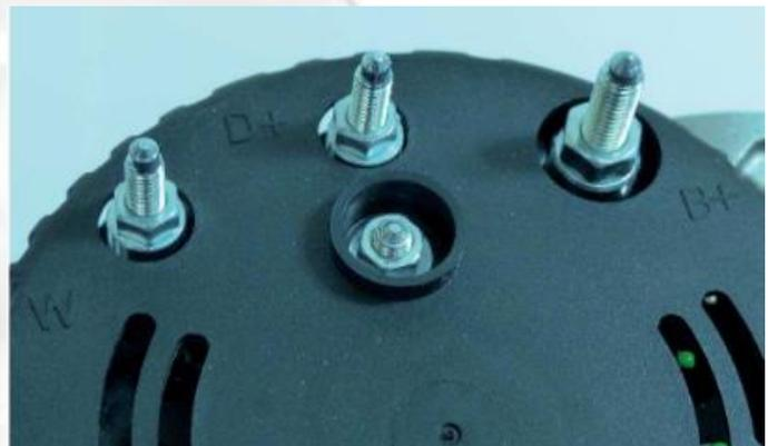
Abbildung 2: Klemmenbezeichnung am Generator: W = Drehzahl-signal, D+ = Ladekontrollleuchte und B+ = Batterieplus
